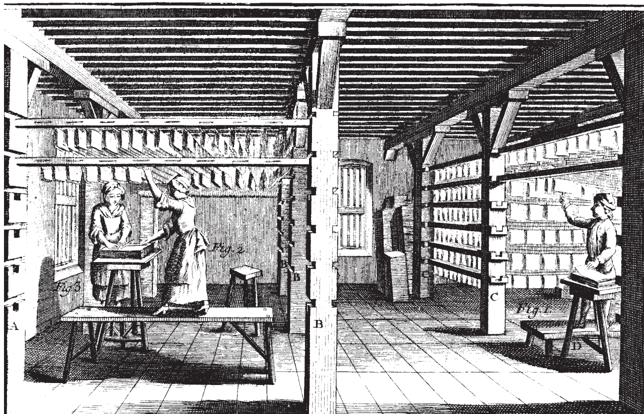
Fig. 14. L'ENCICLOPEDIE Diderot & d'Alembert. Uscarea hârtiei de mână
