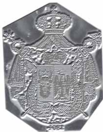
Fig. 2. Clișeu zincografic (metalografie)
