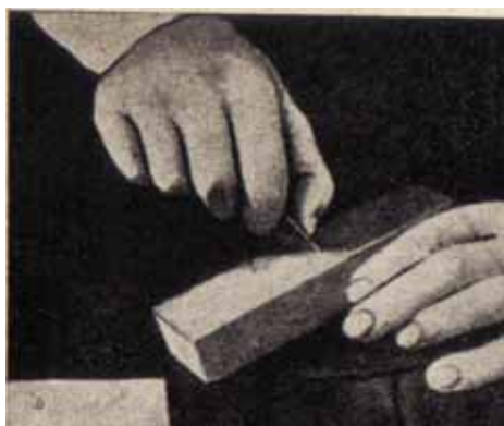
Fig. 28. Ascuțirea dălțițelor pe piatra de Arkansas
